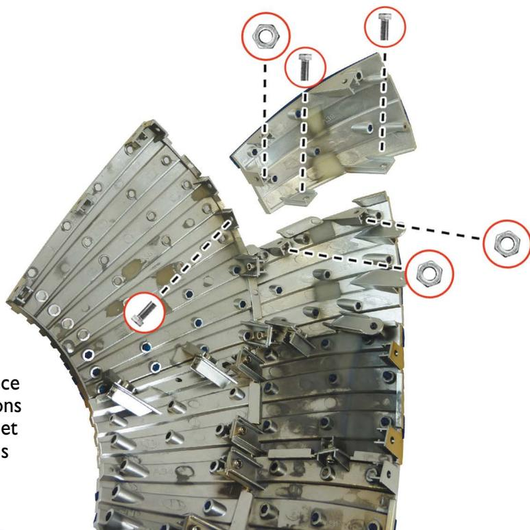
Positionnez la pièce A39 sur la pièce A35 et A38. Insérez les trois boulons dans les emplacements prévus à cet effet. Insérez les vis dans les trous correspondants et visser.
